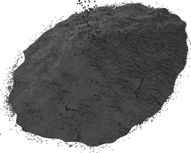
0-4 Sand / Sand / Sable Menge / Quantity / Quantité : ca. / approx. / env. 37 % Bindemittelgehalt / Binding agent content / Teneur en liant : 5.8% (No. 30.1/31.1)
